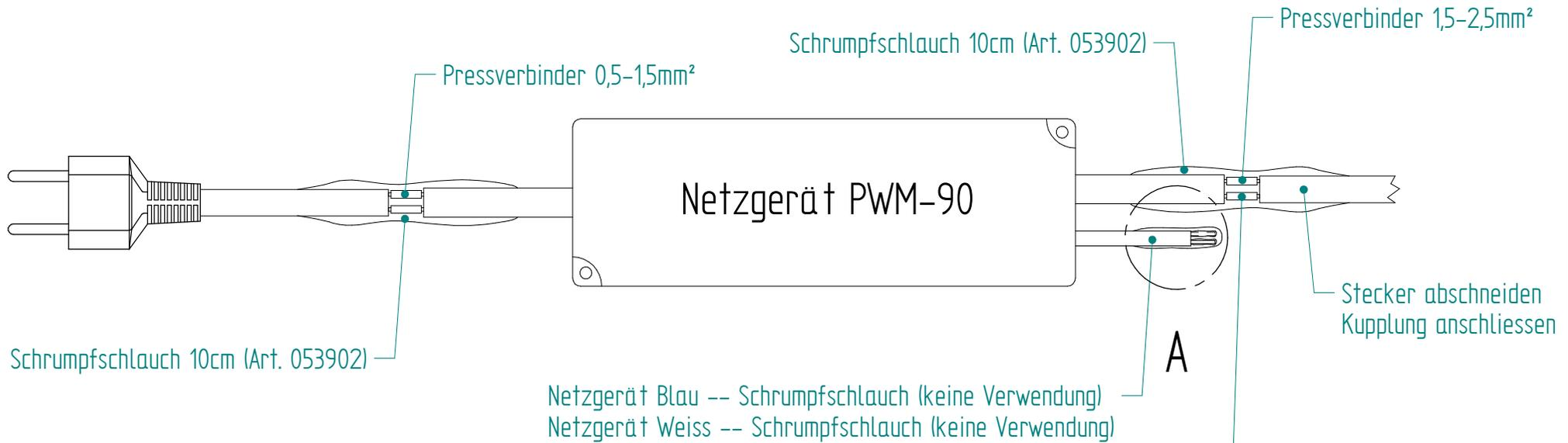
Netzgerät: Rot-verbinden mit- Kabel VisuLED: Braun
